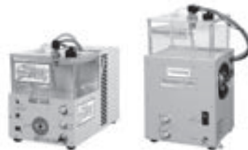
冷却水循環装置
